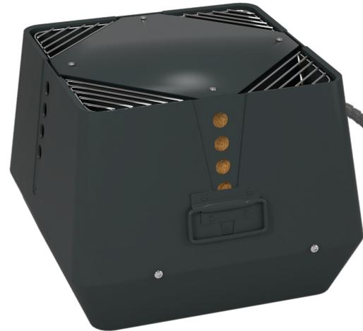
Der Abgasventilator RSV von Exodraft ist ein speziell konstruierter Abgasventilator mit einem vertikalen Auswurf. Oben auf dem Schornstein montiert erzeugt der Abgasventilator einen Unterdruck im Rauchgasrohr und im Schornstein.
