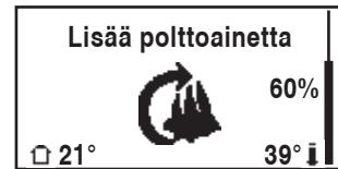
Jos polttoainetta halutaan lisätä, painetaan **OK**, jolloin ohjain säättää imurin säädetylle käynnistysnopeudelle 3 minuutin ajaksi.
