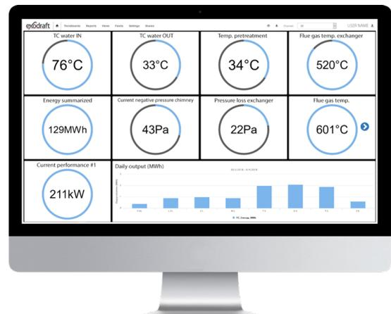
Mit dem Exodraft Trendlog können Sie Ihr Wärmerückgewinnungssystem online überwachen und Ihre Energieeinsparungen live verfolgen. Die Daten aus Trendlog können zudem zur Fehleranalyse verwendet werden und um Optimierungsmöglichkeiten im System zu finden.
