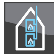
Central rökgasfläkt för fler värmestäder på samma skorsten (gas vattenvärmare)
