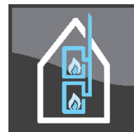
Desentrale varmeanlegg tilkoblet samme skorstein
