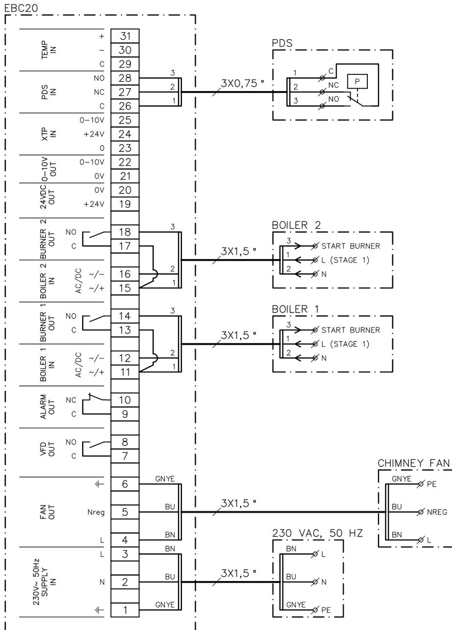
В данном примере показано, какие входы/выходы EBC20 необходимо использовать для подключения 2 котлов с 1-ступенчатой горелкой. Выходом котла для ступени 1 является сигнал напряжения.
