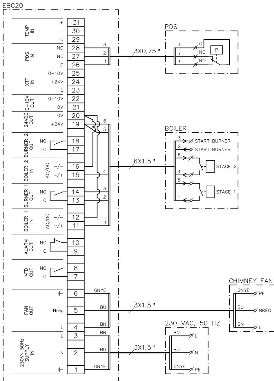
В данном примере показано, какие входы/выходы EBC20 необходимо использовать для подключения котла с 2-ступенчатой горелкой. Выходы котла для ступеней 1 и 2 являются комплектами «сухих» контактов.
