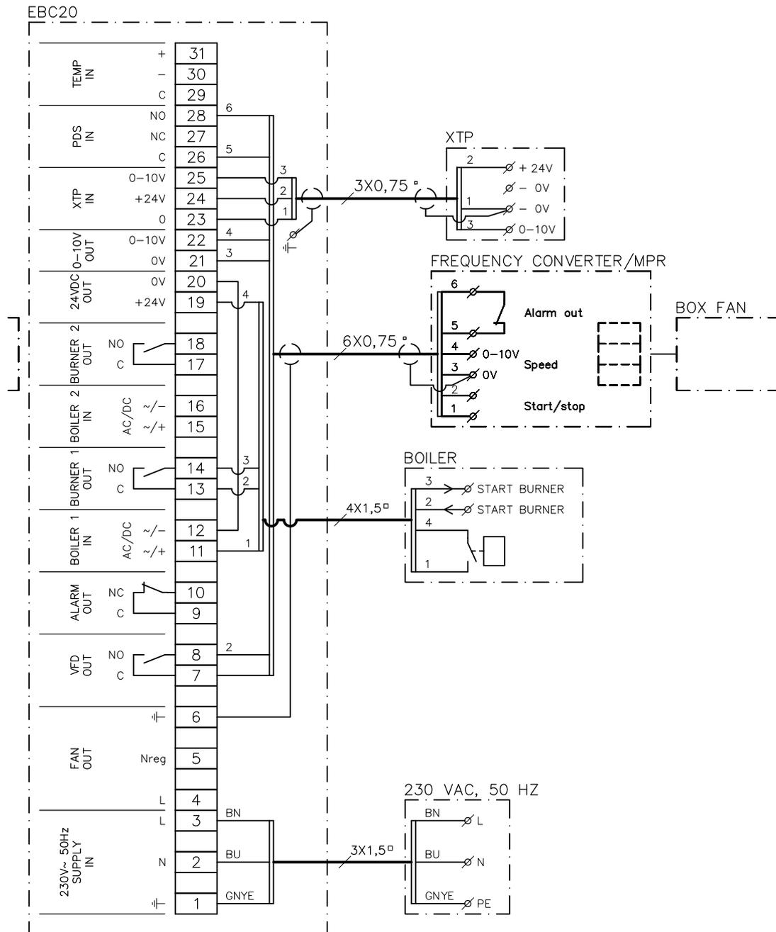
В данном примере показано, какие входы/выходы EBC20 необходимо использовать для подключения преобразователя частоты / реле MPR (защиты электродвигателя).
