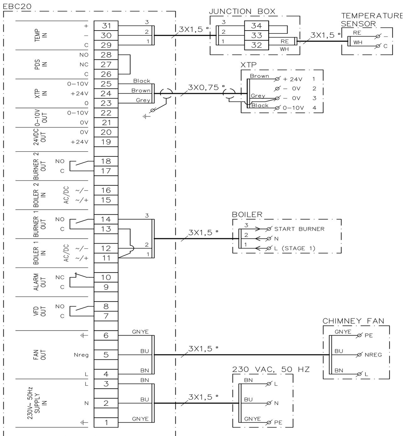
В данном примере показано, как можно включать и выключать вентилятор с помощью датчика температуры в газоходе.
