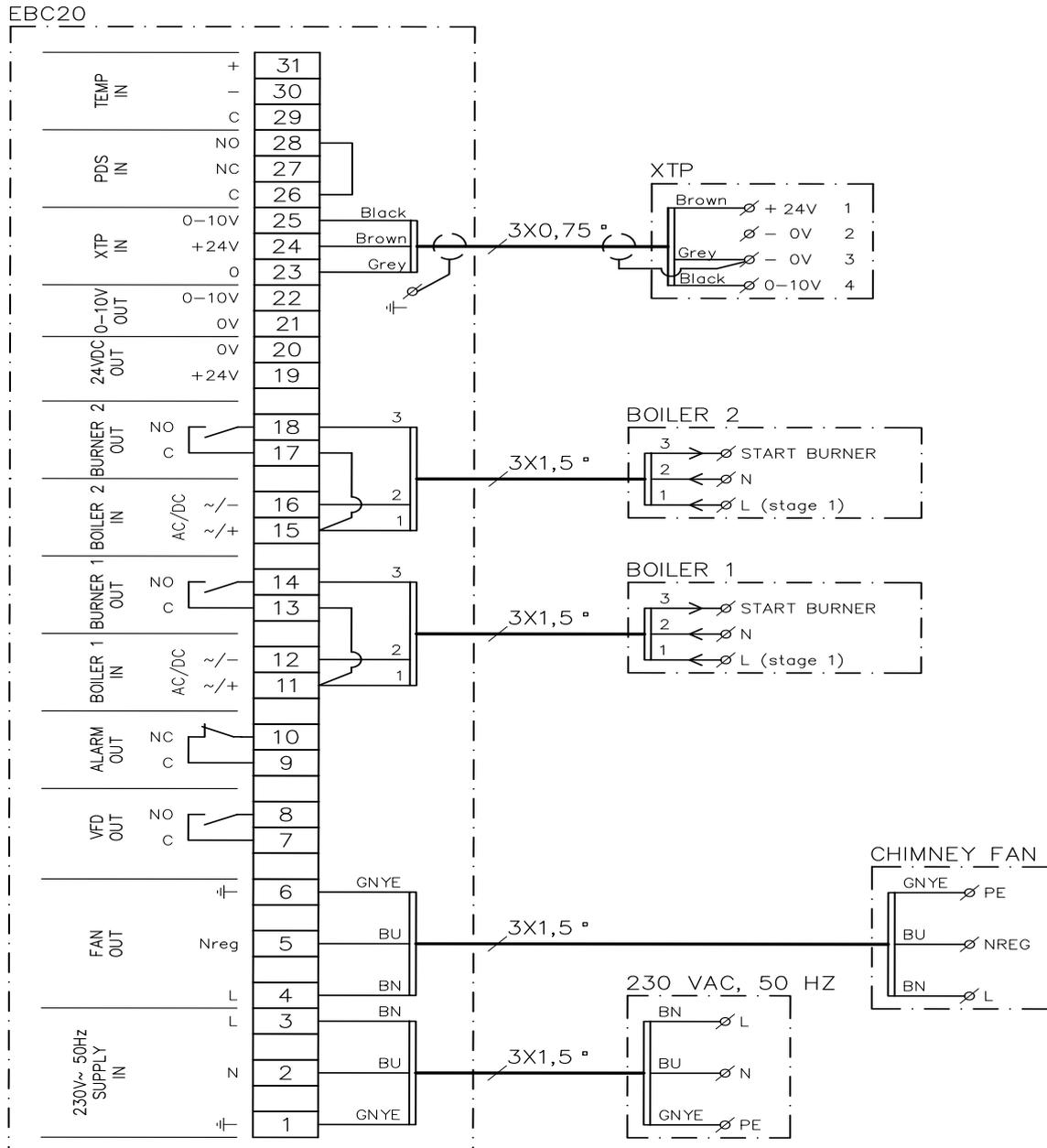
В данном примере показано, как подключить сигнал напряжения (18-230 В переменного/постоянного тока) к EBC20, чтобы запустить/остановить вентилятор от одного или двух независимых котлов.
