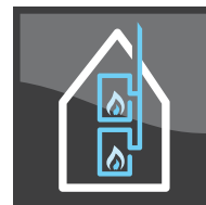
Installations de chauffage décentralisées raccordées au même conduit de cheminée
